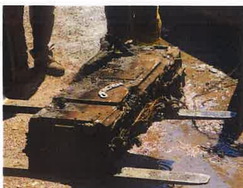
Fot. 22. Bateria po pożarze Źródło: CNBOP-PIB.
