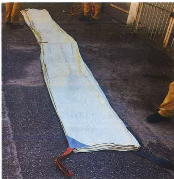
Fot. 1. Płachta gaśnicza typu: FIPROTEX S-TYPE Źródło: CNBOP-PIB.
