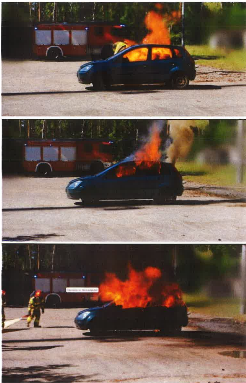
Fot. 4 – 6 Rozwój pożaru Źródło: CNBOP-PIB.
