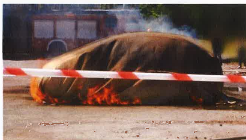
Fot. 19. Pojazd przykryty samochodową płachtą gaśniczą Źródło: CNBOP-PIB.
