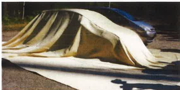
Fot. 3. Próbne założenie płachty gaśniczej typu: FIPROTEX S-TYPE na samochód Źródło: CNBOP-PIB.
